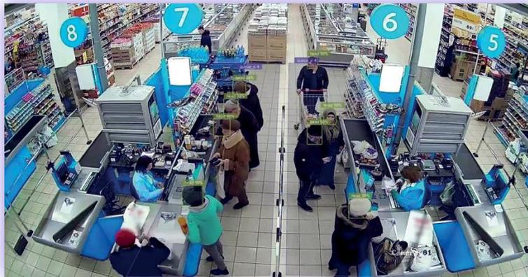
Est un système intelligent d'analyse vidéo utilisant des réseaux neuronaux conçu pour compter les personnes dans une file d'attente
